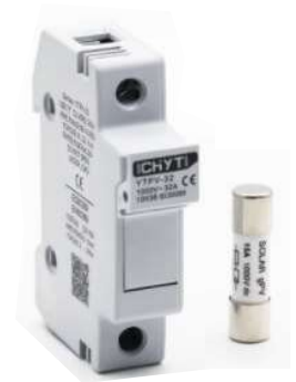
CAJA DE PROTECCIÓN Serie: ZTPV-25B USE 75° CU WIRE ONLY WIRE RANGE: #8-18 AWG TORQUE: 18-22 lb.in RATED:1000 Vdc, 20A TORQUE: 2-2,5 Nm
