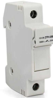
CAJA DE PROTECCIÓN Serie: ZTPV-25B USE 75° CU WIRE ONLY WIRE RANGE: #8-18 AWG TORQUE: 18-22 lb.in RATED:1000 Vdc, 20A TORQUE: 2-2,5 Nm
